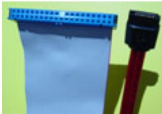
Kabelvergleich: links 80-pol. Parallel-ATA, rechts S-ATA
