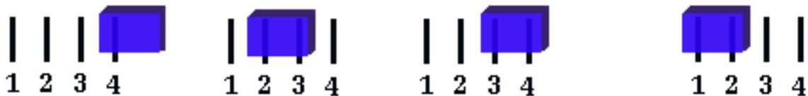
Die Abbildung zeigt die mögliche Anordnung einer Brücke auf einem Jumper mit 4 Kontakten. Ganz links wird die Parkposition für einen nicht gesetzten Jumper gezeigt. Immer wenn eine Brücke nur auf einen Pin gesteckt ist, hat dies die gleiche Wirkung als wenn die Brücke gar nicht gesteckt ist. Nur dann wenn zwei Pinne verwendet werden gilt eine Brücke als gesteckt.
